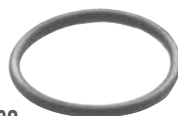
1130 €0,23 Guarnizione OR mm 36,10x43,16x3,53, per resistenza flangiata. Oring washer in NBR mm. 36,10x43,16x3,53, for flanged heating elements.
